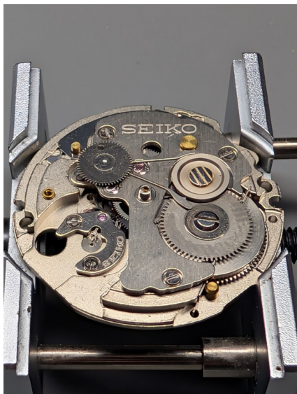
P041 · ponts en place
